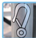
Si le fauteuil doit être soulevé, par exemple à l'aide d'une grue à potence, afin de franchir un obstacle, les seuls Points d'attache à utiliser pour le levage sont les 4 points signalés par l'autocollant représentant un crochet (voir la fig. de gauche) sur le châssis du fauteuil.
