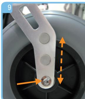
Placez la roue dans la position souhaitée, replacez la vis de l'axe de roue et resserrez-la.
